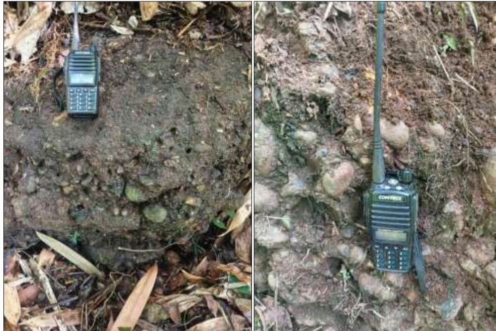
Gambar 5 . Singkapan batuan konglomerat pada sisi selatan lintasan
