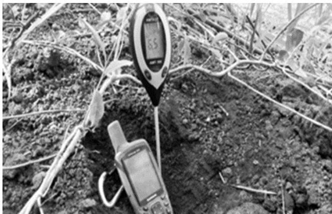
Gambar 2. PH soil sampel "X" A (pada tanah yang tidak terkena aktivitas penambangan)
