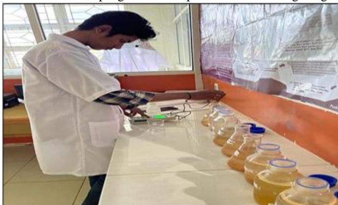
Gambar 4. Proses pengukuran pH sampel air asam tambang.
