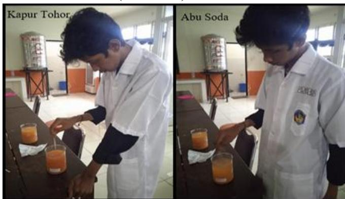
Gambar 3. Proses pengadukan sampel air asam tambang dengan material penetral kapur tohor dan abu soda.
